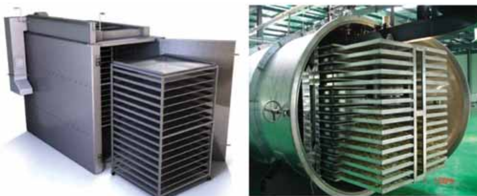
Foto 3. Deshidratador de plátano por aire caliente (izquierda) y liofilizador (derecha).
